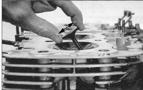
Bild 211 Ventil darf beim Hin- und Herdrücken nicht «knacknen»
